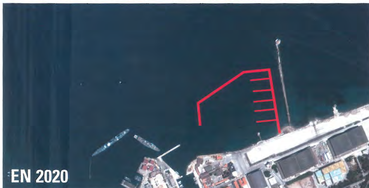
Un brise-clapot et des places d'amarrage pour les yachts verront le jour en face des hangars
