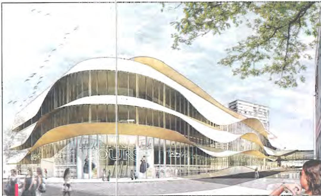
Perspective depuis l'angle rue Bir Hakeim rue Sainte-Élisabeth. Le nouveau toit reprend les techniques de l'aviation avec une structure en aluminium émaillé blanc. Ses courbes suivent le chemin du soleil. L'objectif est de protéger les grandes baies. Ingénieux donc. On est loin de l'aspect bunker du Centre Bourse actuel... À noter, la passerelle sera couverte et élargie. /PHOTOS DR ET PATRICK NOSETTO
