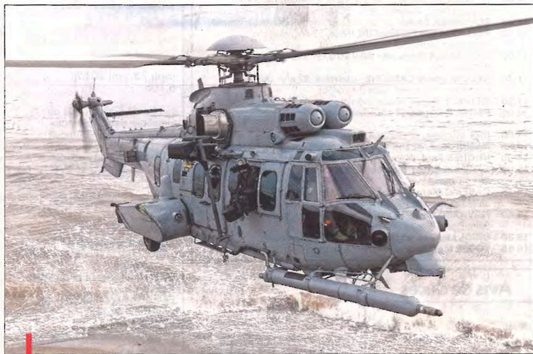
Un "Caracal" vu en vol tactique au raz de l'eau. Cet appareil utilisé notamment par les forces spéciales est reconnaissable à sa perche de ravitaillement en vol télescopique. / PHOTO DR / ANTHONY PECCHI
