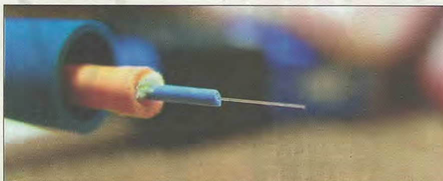
Cette petite aiguille représente une terminaison de câble fibre optique.
