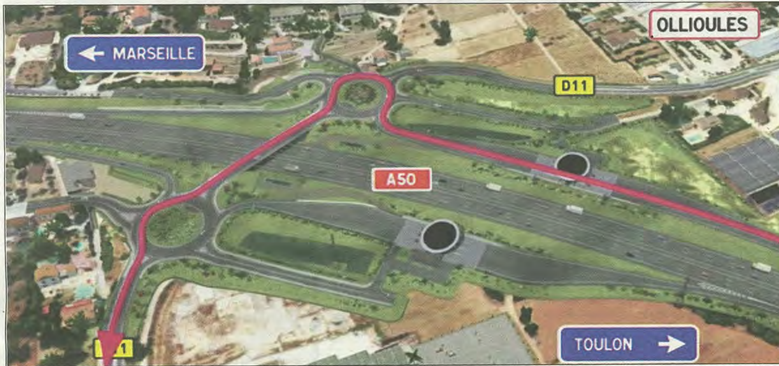
La création de cet échangeur verra sortir de terre deux bretelles d'entrée et de sortie entre la D11 et l'A50, deux gares de péage vers Toulon et venant de Toulon, ainsi que deux carrefours giratoires permettant le raccordement des bretelles à la D11.
